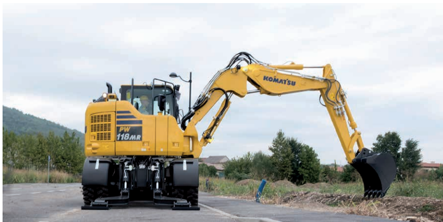
Těžké protizávaží je u modelu PW118MR-11 integrováno přímo do stroje, bez prodloužení jeho zadní části
