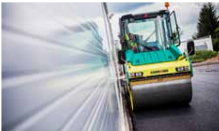
ARX 90 T4i - snížené vibrace přenesené na kabinu znamenají menší únavu obsluhy a zároveň síly aplikované na hutněnou plochu
