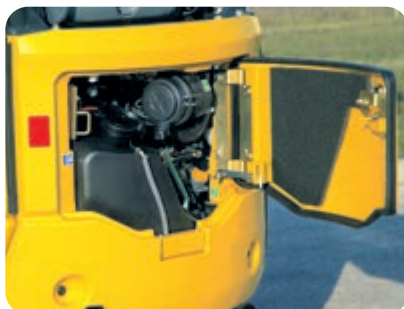
Zadní kapota: rychlá kontrola motoru a doplňování palivové nádrže
