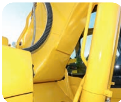
Základna výložníku z odlitku a plechy výložníku z jednoho kusu
