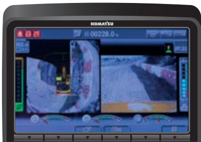
Díky funkci KomVision jsou dostupné různé volitelné možnosti nastavení pohledu kamery při současném zachování stálého „pohledu z ptačí perspektivy“, tedy pohledu shora na pracovní oblast stroje
