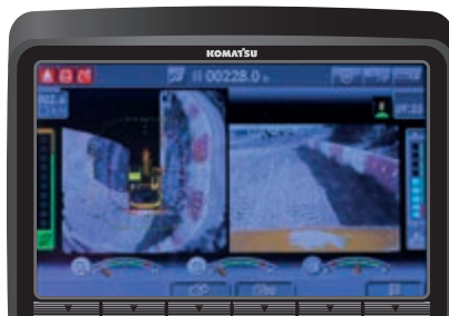
Díky funkci KomVision jsou dostupné různé volitelné možnosti nastavení pohledu kamery při současném zachování stálého „pohledu z ptáčích perspektivy“, tedy pohledu shora na pracovní oblast stroje
