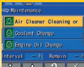
Panel s multifunkčním monitorem poskytuje obsluhu informace o údržbě a servisních intervalech
