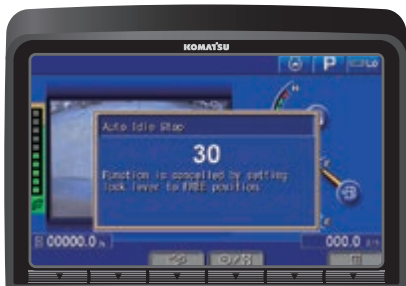
Ukazatel Eco, průvodce Eco, nastavitelné vypínání motoru při volnoběhu a nová funkce automatického volnoběhu dále snižují spotřebu paliva
