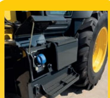
Nádrž pro přísadu AdBlue®, palivová nádrž i nádrž hydraulického oleje jsou snadno přístupné na boční straně stroje a doplňování kapalin se provádí z úrovně terénu, což představuje méně únavný postup
