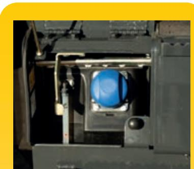
Nádrž pro příсадu AdBlue®, palivová nádrž i nádrž hydraulického oleje jsou snadno přístupné na boční straně stroje a doplňování kapalin se provádí z úrovni terénu, což představuje méně únavný postup
