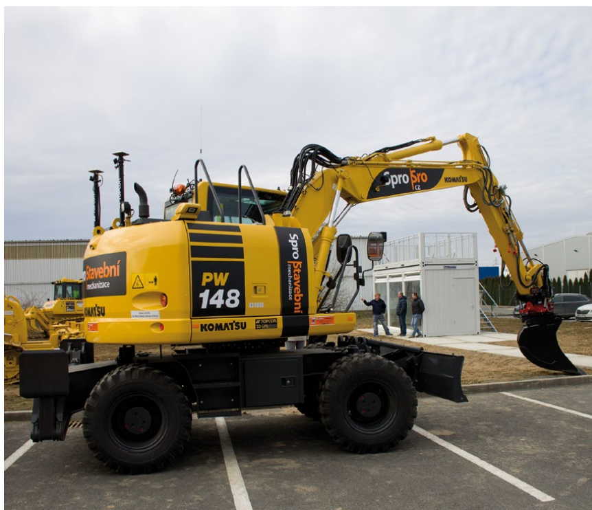
Kolové rýpadlo PW 148 s technologií 3D-GPS
