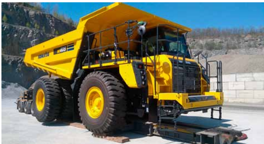
Korba z vysokopevnostní oceli má objem 40 m 3
