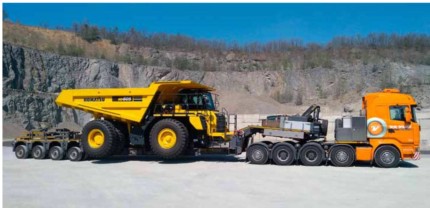
Korba z vysokopevnostní oceli má objem 40 m 3
